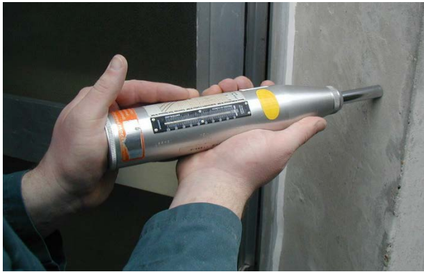
Figuur 2: Meting van de oppervlaktehardheid met de sclerometer
