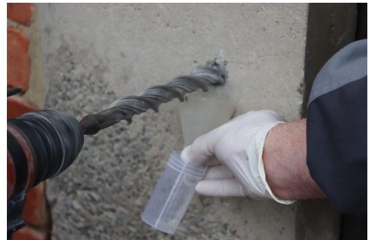
Figuur 4: Het ontnemen van boorstof voor de bepaling van het chloridegehalte
