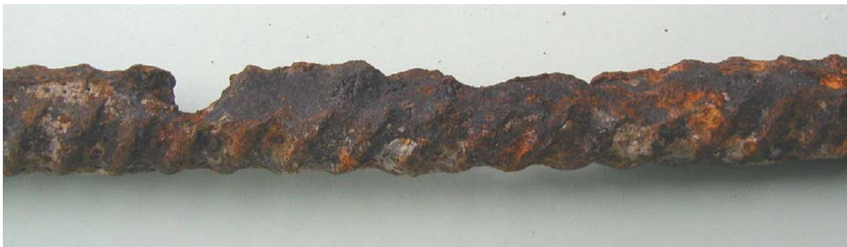
Figuur 9: Putcorrosie, veroorzaakt door chloriden
